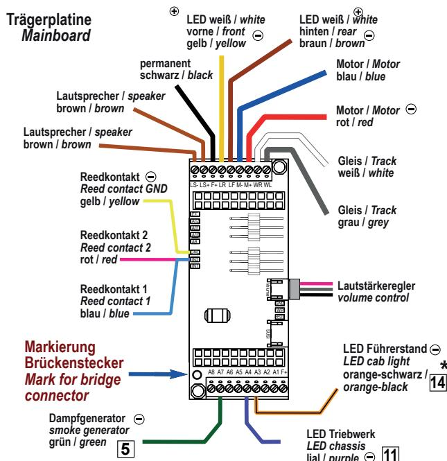
Entfernen Sie vorsichtig den Brückenstecker. Bitte nehmen Sie beide Hände, um ein Verkanten / Verbiegen der Kontakte zu vermeiden. Stecken Sie den Decoder auf die Trägerplatine. Durch seine Bauform lässt er sich nur in passender Position aufstecken. Achten Sie bitte dennoch darauf, dass die Kontakte nicht versetzt eingesteckt werden. Sollten Sie wieder auf Analog umrüsten, gehen Sie in umgekehrter Weise vor. Achten Sie beim Brückenstecker / Trägerplatine auf die Markierung.
